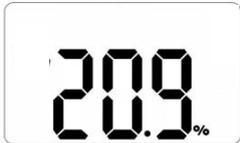
제품이 안정화 되어, 측정모드로 정상 진입되면 LCD화면에 가스의 농도 또는 사용 가능 잔여시간(SGT-IR Link 소프트웨어에서 설정)이 표시됩니다. 가스의 농도는 산소의 경우 단위는 %vol로 표시되며, CO, SO2, H2S, Cl2, NH3 등과 같은 독성가스의 경우에는 ppm단위로 표시됩니다.
