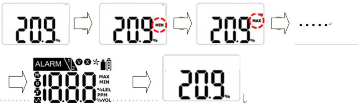
버튼을 가스 측정 모드에서 1회씩 짧게 누르면, **Min**(산소 모델만 해당) -> **Max** -> **Clr** -> **사용잔여시간** (M, D, T) -> **1차 경고 설정값** -> **2차 경고 설정값** -> **펌웨어 버전** -> **가스보정 농도 값** -> **측정 모드** 복귀로 반복 됩니다. 각 모드에서 일정시간 동안 사용이 없을 시, 가스 측정 모드로 되돌아 갑니다. clr가 표시된 상태에서 버튼을 길게 누르면, Min, Max값이 초기화 됩니다. 사용가능 잔여일은 (M, D, T)아이콘과 함께 숫자로 표시되며, M과 함께 표시되는 숫자는 월 단위를 표시하며, D는 일 단위를, T는 24시간 이내의 시간을 표시합니다.
