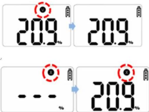
如果校准正常完成，则显示 **V** 图标，并返回到气体测量模式。
