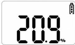
当产品稳定并进入正常测量模式时，液晶显示屏上会显示气体的浓度或剩余可用时间（由SGT-IR Link软件中设置）。对于氧气，气体浓度以%vol单位显示，对于诸如CO，SO<sub>2</sub>，H<sub>2</sub>S，Cl<sub>2</sub>和NH<sub>3</sub>的有毒气体以ppm单位显示。
